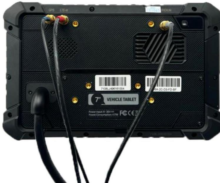
Figura 3 - Connettori antenne
